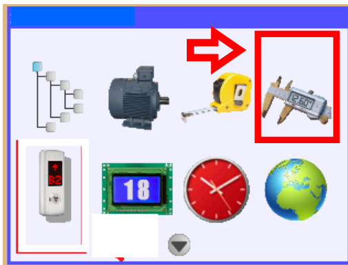
Bild 11. AREM-display: "tools"-meny och symbolen för "Finjustering Plan".
