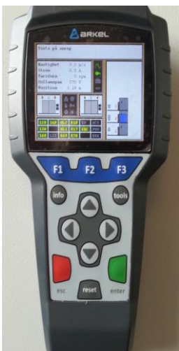
Bild 7. Handenhet AREM till Arcode-system. Används för styrning, kontroll, tester, parameterinställningar etc. Ansluts mot Arcodes Bus-system.
