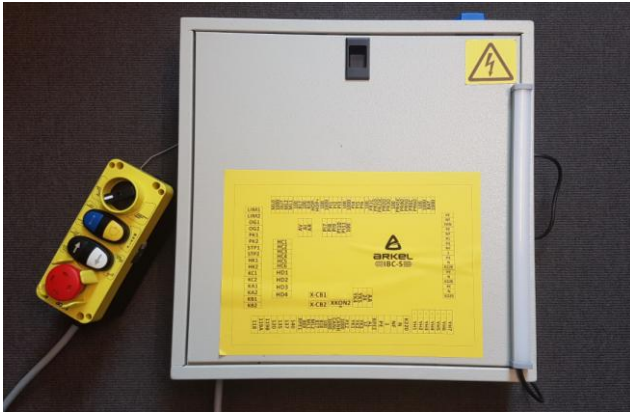
Bild 5. Taklåda med bl. a kretskort IBC-S och förmonterat Inspektionshandtag. Kretskort IBC-S är modifierat beroende på krav i EN81-20. Detta gäller även Inspektionshandtaget.
